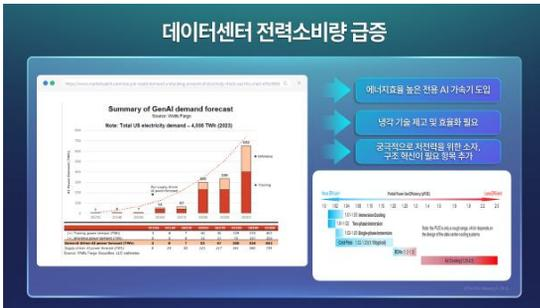
첫 번째는 전력 이슈입니다. 단순히 전력 소비량이 많아진다는 수준을 넘어서 전력 밀도(Watt/mm<sup>2</sup>), 그리고 발열과 냉각 문제로 인해 시스템 설계 및 성능에 제약 받고 있습니다. 생성형 AI로 인해, 미국 데이터센터의 전력 수요가 향후 증가하는 모습을 이 그래프가 보여주듯이, 에너지 인프라 및 환경과 관련된 사회적 이슈로도 확산되고 있습니다. 현재 이에 대한 대응방안으로, 아직은 활용범위가 제한적이지만, 에너지 효율이 높은 전용 AI 가속기 도입을 진행 중에 있고요, 또한, 발열 문제들에 대한 방안으로 기존의 공랭방식의 냉각에서 최근에는 액침냉각까지 에너지 효율성이 높은 냉각기술로의 전환이 이루어지고 있습니다. 이러한 기술들로 연산량이 폭발적으로 증가하는 AI 워크로드를 감당하기 어렵기 때문에, 궁극적으로는 전력 자체를 줄이기 위한 구조 및 소자의 전환 및 혁신이 필요할 것으로 생각합니다.
