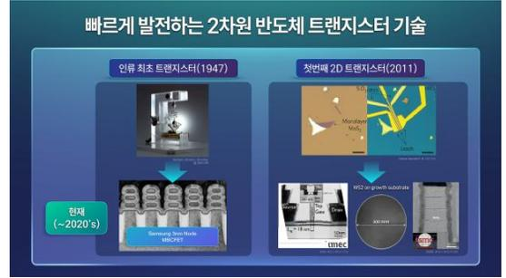
반면, 2차원 트랜지스터는 2011년에 처음 실험실 수준에서 만들어졌습니다. 초기에는 매우 조잡한 형태였지만, 현재는 삼성, TSMC, 인텔 같은 세계적인 반도체 기업들이 직경 300mm 웨이퍼에서 10나노미터 채널 길이를 가진 2차원 트랜지스터를 제작하는 데 성공했습니다. 물론 아직 소재 특성이나 소자 성능, 안정성 등 해결해야 할 과제가 많습니다. 그럼에도 불구하고, 불과 12~13년 만에 이뤄낸 이러한 진전은 기존의 성숙한 반도체 기술들을 기반으로 가능했던 일입니다.
